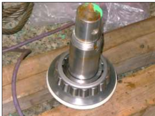
写真⑤ 軸受部交換状況
